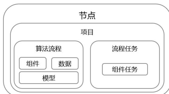
图 1 多方安全计算节点示意图
